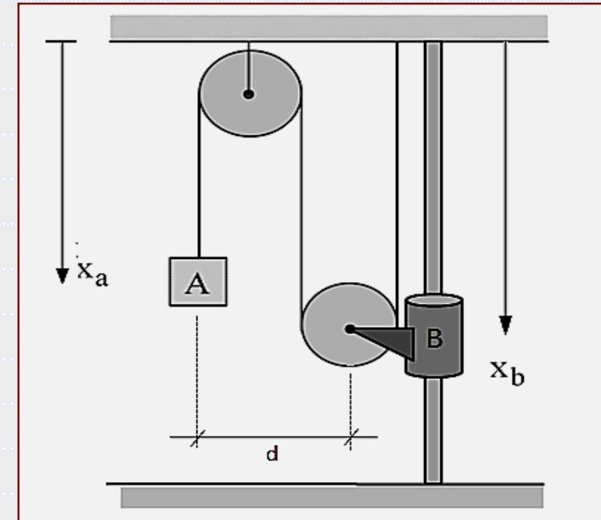
$$(x_A - c_1) + c_2 + (x_B - c_3) + c_4 + (x_B - c_5) = c$$
